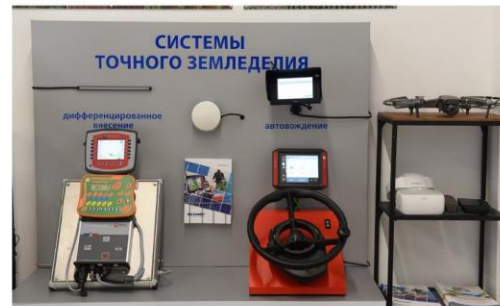
Учебный стенд «Системы точного земледелия» с квадрокоптером Mavic Pro 2 с очками виртуальной реальности DJI
